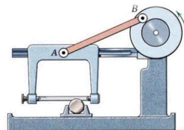
يوضح الشكل المجاور منشار لقطع المعادن يعمل بشكل آلي من خلال وصله بمحرك كهربائي يدور بسرعة زاوية ثابتة.
